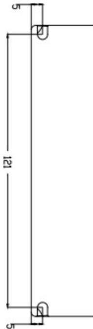
图 2-1 2CL3-EC403T/507 安装尺寸图(单位: mm)
